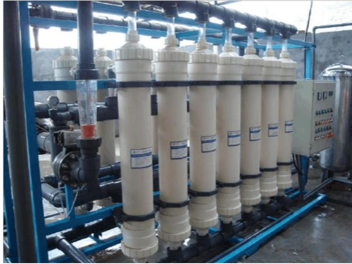
保养注意事项:1) 超滤组件停止运动时,必须进行充分清洗,然后密封保存.2) 超滤组件必须湿态保存,内部任何时候必须充分满水;如断水干燥,通量将下降为零且不可逆转,组件即报废.3) 组件如长期停用(10天以内),每三天换水一次,以防细菌污染.4) 组件长期停用(10天以内),应配制0.5%甲醇水溶液或0.3%双氧水浸泡,切每月检查一次,夏天环境温度应在25℃以下,以防霉变,冬天须防冻,必要时可加入10-20%甘油.5) 组件如发生霉变,可用灭菌液浸泡及循环清洗至霉斑消失为止.中空纤维管壁上布满微孔,孔径以能截留物质的分子量表达,截留分子量可达几千至几十万.福建不锈钢超滤设备供应
